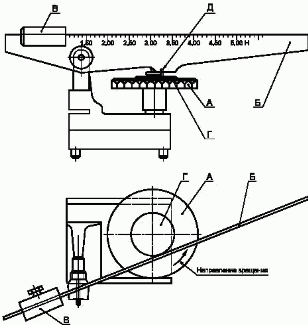
Рисунок Д.1 — Установка для нанесения царапин
